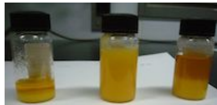
図3 実サンプルの融液晶析処理前後(冷却管回転速度:100rpm、冷却速度:0.2 K/min)の状態(左:処理後の晶析物、中央:処理前のスラリー状の仕込み(バイオ重油)、右:処理後の残液(精製バイオ重油))
