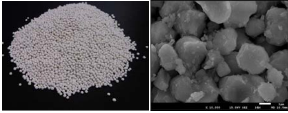
図 6 AgX 耐久性試験結果 (10 時間後 SEM 画像)
