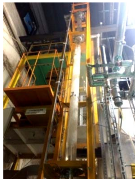
図2 フィルターベント可視化試験装置
