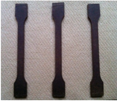
写真1. タンニンとスクロースを接着成分とした木質成形体
