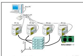
図2専用計算機クラスタシステム概略図
