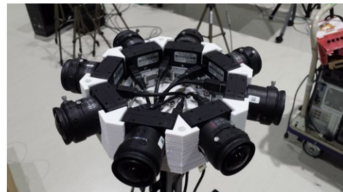
図1: カメラクラスタ(水平面上1次元全周配置)の構成
