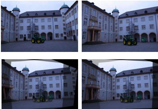
図5：ビューモーフィング法により2枚のカメラ画像から自由視点映像を生成した実験結果。上段：元のカメラ画像。下段：生成された自由視点画像。
