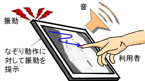
図6．振動による触感提示の仕組み
