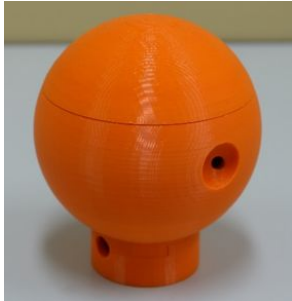
図 2: 3D プリントで作成したくぼみ付き球状マイクロホンバッフル(直径 10 cm)
