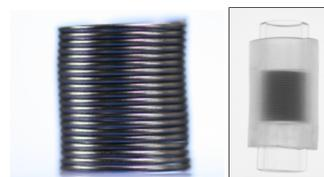
図6 Au-5Pt-7Nb 合金製試作コイル（左）と MRI 撮影用のセッティング（右）
