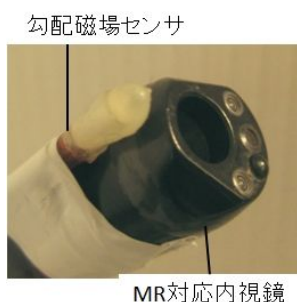
図 1. MR 対応内視鏡先端に搭載した勾配磁場センサ
