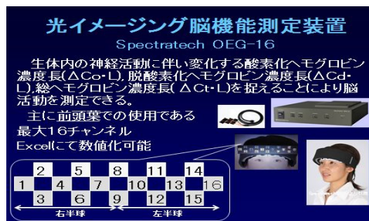
図1 光イメージング測定装置(Spectratech OEG-16)の説明図
