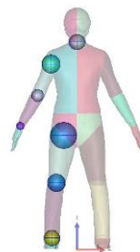
図1 人体形状データの関節に球関節を当てはめ、関節可動性を与えた形状データ
