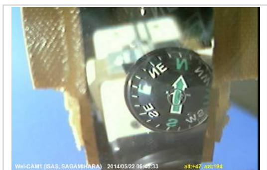
図6: 副カメラから見たボールコンパス(太陽が映り込み、その方位が分かる)
