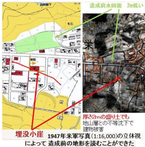
図3 谷底の浅い盛土地盤の不等沈下とすべり
