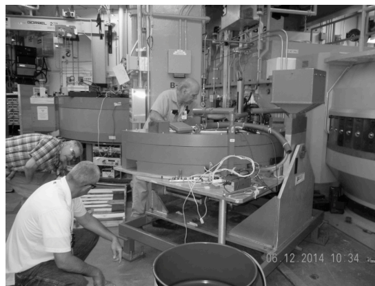
図2 米オークリッジ国立研究所に研究代表者が設置した広角中性子回折装置 (WAND) 上図は新設の 2D ディテクター。
