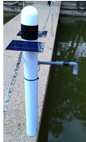
図-1 超音波センサーで水位を観測する水位モニタリングノード。ソーラーセルによる自立電源駆動で 3G 通信を行い、Twitter へデータを送出する。
