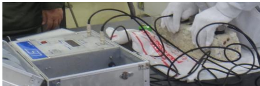
写真12 スケーリング供試体の表面走査
