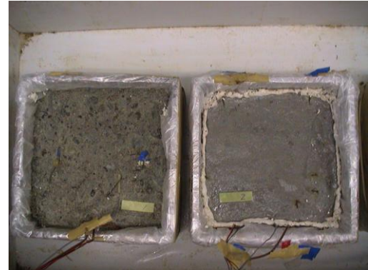
写真5 ASTM C 672 による稀釈促進の検証
