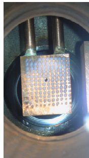
図2 銅ブロック上に生成されたドライアイス(白点)点状になっているのは、噴霧器のガス噴出口の構造を反映しているため。銅ブロック上部に見える2本の銅製パイプ中を液体窒素が流れている。
