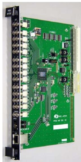
図 3: 開発された時間測定モジュール
