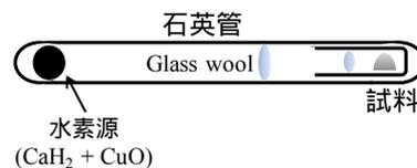
図 2. 独自の水素化合物合成法に用いた水素化セルの概略図。
