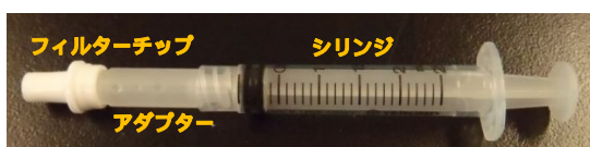
図 1 市販目視分析キットに付属するフィルターチップ、シリンジ、アダプターの外観
