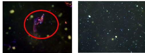
図4. クリソタイルの処理前(左)後(右)の分散染色・偏光顕微鏡写真。処理後アスベスト含有率は0.1%以下。
