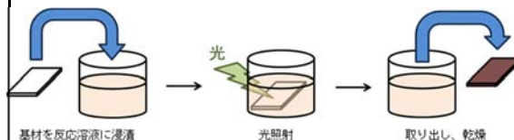
図 3 金属/導電性ポリマーの作製過程
