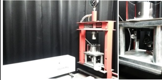
図1 パルスレーザー発振器および手動油圧圧縮試験機
