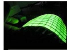
図 1.2 GE のフレキシブル照明試作例
