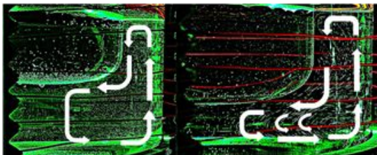
図2 自然対流によるつば内の流れ (左：2000ml, 右：1500ml)
