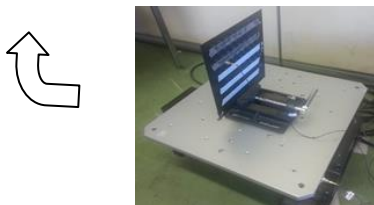
図 2. 加振実験による固有モード解析
