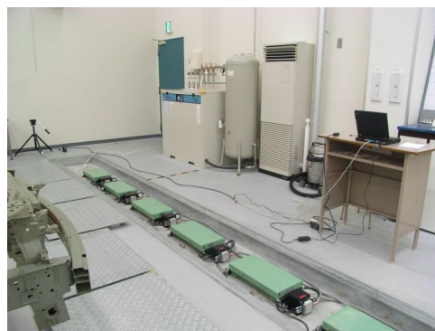
図4 衝突実験用リニア誘導モータ (LIM)
