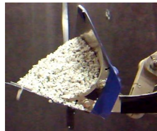
図5 側面条件を変えた崩落実験
