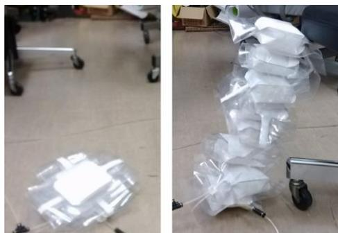
図 13 多室式封筒型アクチュエータ
