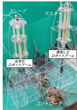
図10 改良した柔軟ロボットアーム
