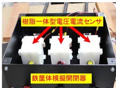
図6 模擬開閉器に収められた樹脂一体型電力センサ
