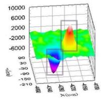
(2)接合した単結晶基板上に蒸着した 123 系 超伝導薄膜の粒界付近での侵入過程の直接 観察を行った。外部磁場を印加することにより遮蔽電流と磁束の相互作用による粒界へ入り込む様子の直接観察に成功した。
