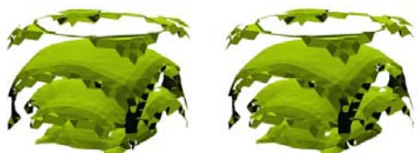
図3 アレイアンテナからの電波放射の視差像(波面表示)
