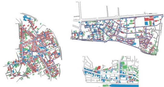
図 9. 本手法で検出した、岩手県大槌町 (左)、仙台市宮城野区 (右上)、釜石市 (右下) での、家屋の 2011 年の震災と津波による消失 (赤で示す)、2013 年までに新たに出現 (青で示す) を表す. 緑は両時期に共通している建造物である
