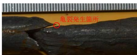
図-8 局部腐食状況 (鋼線 No.32)
