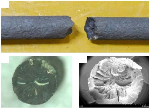
図-13 水素脆化割れ試験後の破面観察結果
