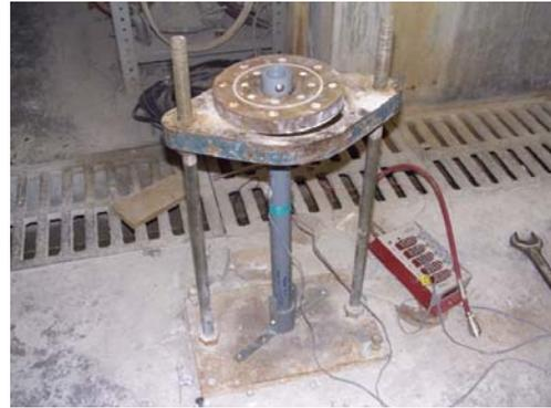
写真-5 引張試験装置
