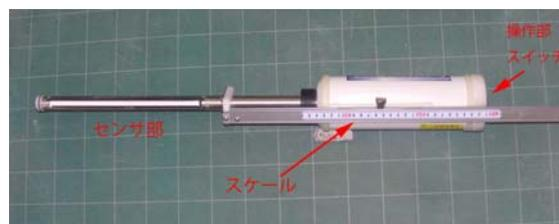
写真-7 高解像度棒形スキャナの外観
