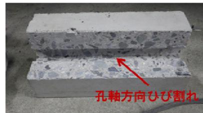
孔軸方向ひび割れ供試体
