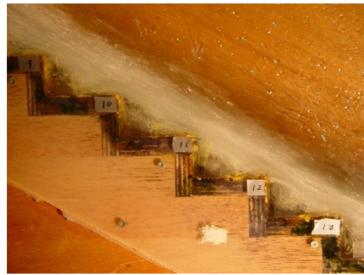
図-2 階段状水路の空気混入流 (水路傾斜角度 \theta=30^\circ )
