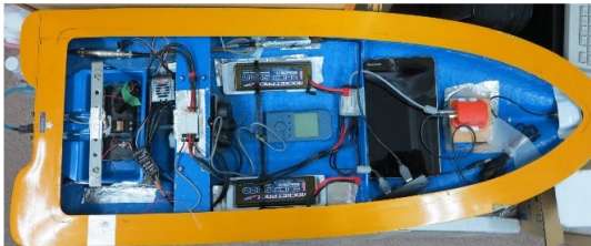
図 2 6 自由度運動解析システムを搭載したラジオコントロール模型船
