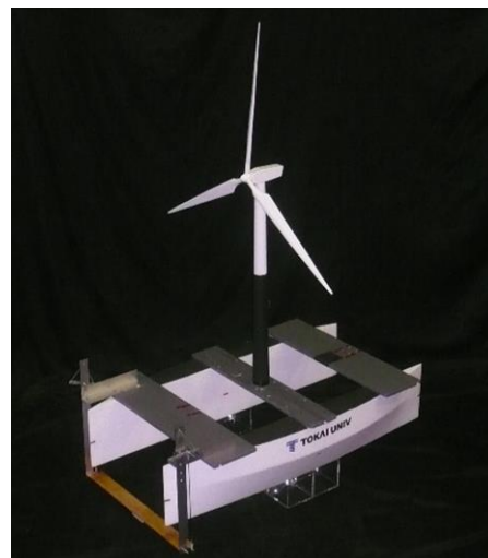
写真1 想定実機の1/50縮尺模型
