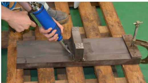
図3 ピーニングの施工中の様子
