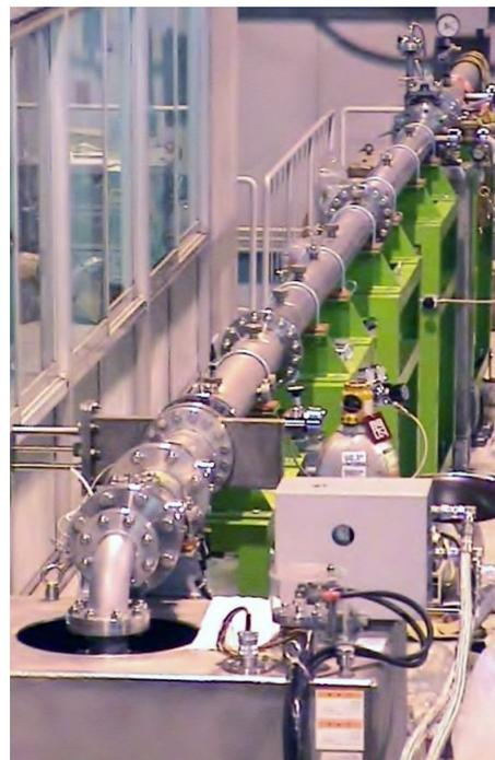
図 1 衝撃波管駆動 MHD 発電装置
