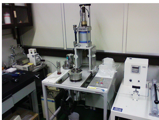
図3. 構築した高圧ストップフロー分光・蛍光光度計システム
