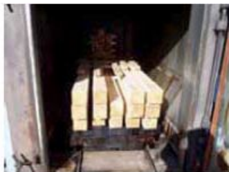
図3 乾燥実機内に棧木電極を使用して棧積みした製材
