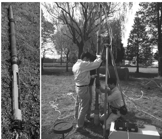
図 3 製作した揚水装置(左)と、井戸に挿入する様子(右)
