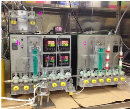
図 2. 装置の外観 (a. F-18イオン濃縮精製装置、b. 標識合成装置、c. 二次反応・精製装置)
