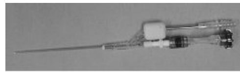
図2. 実験用ハンドピース型パルスジェットメス(ステンレスノズル)
