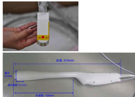
図1: 開発した光音響リニアプローベ(上)と経直腸プローベ(下)
