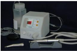
していることが明らかなう蝕の除去時にも施術時間が長くなることが危惧される。 そこで、第1号機と同様のLD光源を採用し、マイクロエンジンモーターを切削動力とする第2号機を試作した(写真)。
