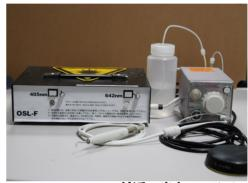
405nm の LD を **80mW 付近の出力**で照出すると、実用的なう蝕罹患歯質認識効果が得られることが確認できた。(上: L D光源と切削動力装置を組み合わせたプロトタイ
