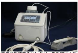
音波発振装置のハンドピース先端に小型 LEDを埋め込んだ試作第3号機を製作 するに至った。(写真)
