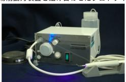
プ。下:LD光源と切削動力装置が一体化した完成した第1号機)
