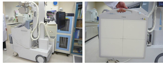
図 2 動画対応ポータブル X 線撮影装置 (試作機)
