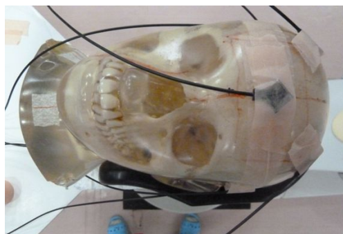
図8 頭部ファントムを用いた透明性の評価実験のセットアップ
