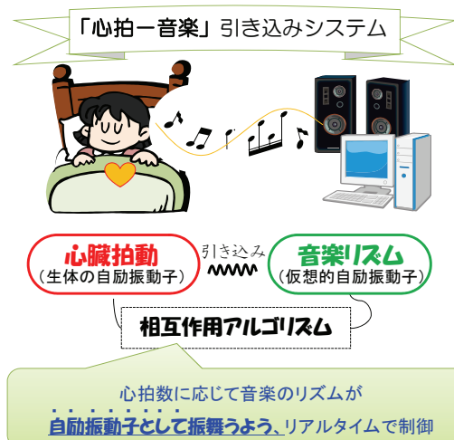
図1: 本研究のスキーマ: 自励振動子(非線形振動子)の引き込みモデルを用い、音楽のリズムを心拍数に応じて自励振動子の様に制御して、心拍数の引き込みを実現する。
